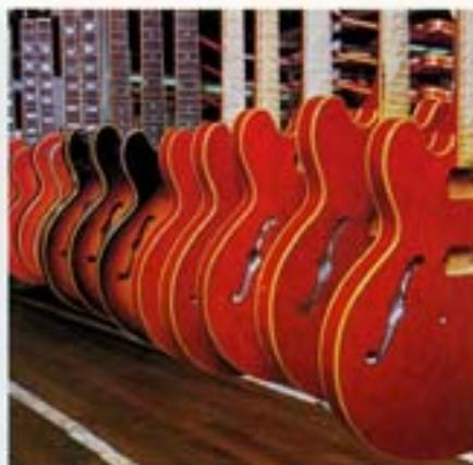
塗装をはじめとする全てのセクションは極めて厳密な品質管理、行程管理の元に行なわれている。塗装セクションはチリ、ホコリなどを完全にシャットアウトした2層のカーテン、エアカーテンで仕切ってある。
