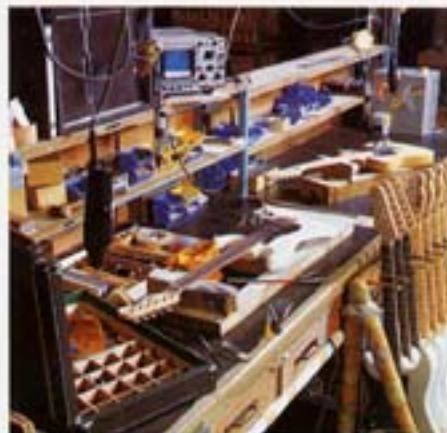
最終チェック工程で製作されたギター。ベースは全てチェックを受ける。ネック調整、ナット調整、弦高調整、オクターブ調整、サウンドチェックなどが行なわれ、これにパスしたものだけがグレコとして世に出る。
