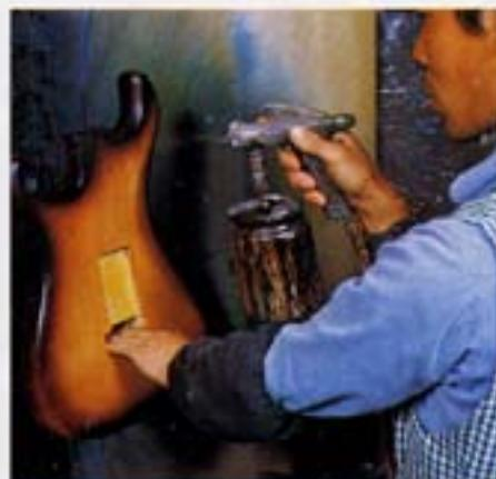
ディッチャップルモデルの塗装は木材の特徴を生かした技術が用いられる。アルダーボディ、センボディなどボディ材による木目の出かた、フィニッシュの違いなど、厳しいチェック、管理の後、はじめてバスとなる。
