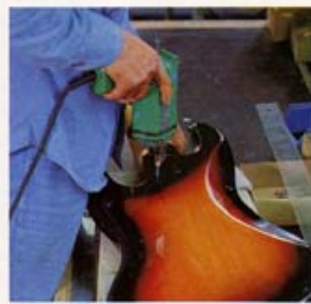
ネック工程。ボディ工程と別々に流れていたディッチャップルラインを1つにまとめるネックセット工程。熟練したグラフマンが一本一本手作業、ネックの真骨を確かめながら作業を行い、ネックを固定していく。
