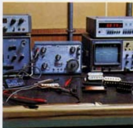
研究開発部門におけるピックアップのチェック、測定はサウンドをクオリティ高いものにするために必要不可欠なものだ。いくつものピックアップ測定、データを作成し、ピックアップのグレードアップを図っている。
