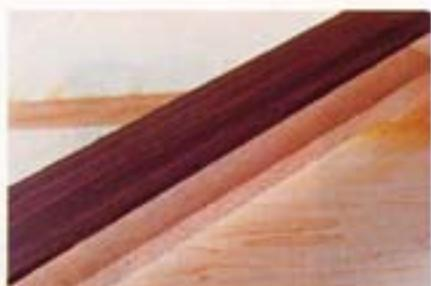
充分にアク抜きを行ない、自然乾燥、人工乾燥、二次乾燥を経て初めてネックにセットするローズウッド指板材。しっかりと指先になじみ抜群のタッチを生み出すグレコ独自の乾燥基準を設けて管理を行っている。
