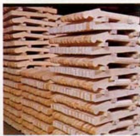
メイプルネック材はカナダより直輸入したハードメイプル材を使用。現地での自然乾燥、人工乾燥、工場での自然乾燥、人工乾燥を繰り返し、完加工の後シースニングを行い、狂いの無い安定したネックとしている。
