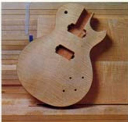
カナダ現地で選別し直輸入している、堅く、木目の綺麗なメイプル材。現地での自然乾燥、人工乾燥、そして工場での自然乾燥、人工乾燥により含水率を楽器として最高値の5~6%にまで落して加工している。
