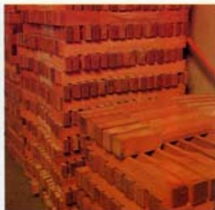
グレコでは原木を工場内で製材し、木目の通っている最高の材質のみをネック材として使用している。自然乾燥、人工乾燥、壳加工、二次乾燥、シーズニングなど長い歳月をかけてはじめてネックとして加工に入る。
