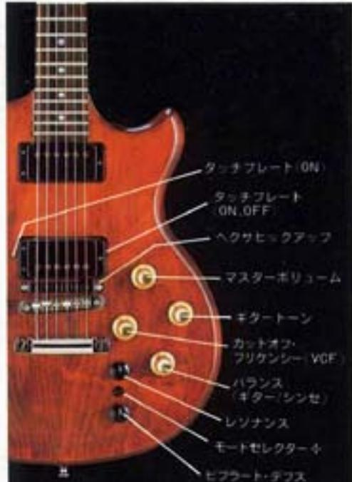
モードセレクターは使用するユニットによってその働きが変わります。GR300の場合は(上)VCO(中)VCO+ディストーション(下)ディストーション。GR100の場合は(上)エレクトロ・サステイン(中)エレクトロ・サウンド(下)ノーマル・ギターとなります。
