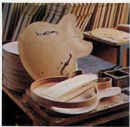
メイプル、マホガニー、メイプルの三層構造を持たせたスーパー・リアルセミアコースティックボディ。トップ、バック、センターブロック&サイドリムの接面には細心の注意をはらって工程を進めて行く。
