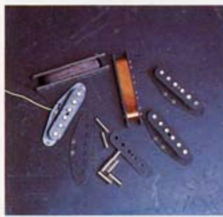
研究開発のために試作したいくつものピックアップ、コイルを変え、磁力を変え、マグネット材を変え、ボビンを変えて、いくつものデーターを作成し、この後、多くのプロフェッショナルにヒアリングされる。
