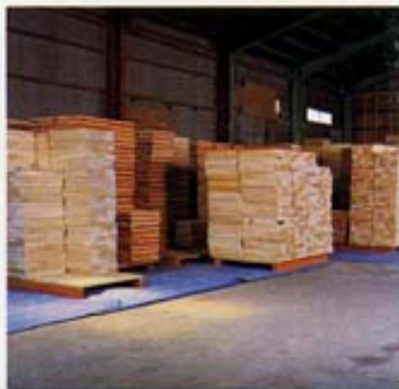
メイプル材、アルダー材、セン材、マホガニー材などグレコのあらゆるモデルのボディ材がこのようにして加工されボディとなるのを待っている。整然とレイアウトしてある屋内は通風性、通気性の条件に満ちている。
