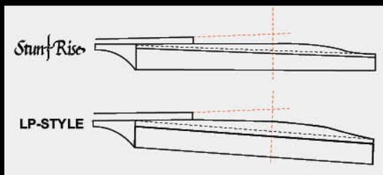
ボディバックを通常の直方体からボディ後方へ向かってテーパ加工した後にボディトップを接着、アーチを成型する独自の構造。ボディ前方のジョイント部からブリッジ位置までボディ
