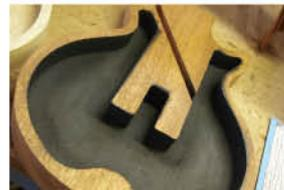
メイプルトップ、マホガニーバックの王道スベックに、音の芯を残しながらも極限まで内部を空洞化する、オリジナルセミホロー構造を採用。ボディ上部のカッタウェイ付近まで全体的に空洞化を行い、更にはブリッジがマウントされるスタッド部周辺も徹底したルーティングによって掘り込む事で、比較的ヘビーウェイトになり易いスタイルにあって平均 3.5kg の軽量化を実現しました。これにより、抜けの良いタイトなソリッドテイストサウンドに共鳴の響きが加わった高い表現性を実現しています。
