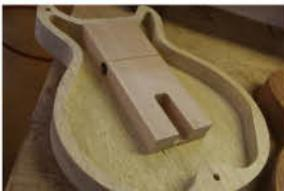
空洞部分のみをくり貫く通常のチェンバー構造とは異なり、一度ボディ全体をくり貫き、その上でセンターブロックを配置しています。この構造により、セミアコースティックギターの生鳴り、音色により近付いたサウンド特性を持つ事が出来ます。更にはセンターブロックにメイプル材を使用する事で太くマイルドな音色の中にも歯切れの良さや輪郭の美しさを併せ持った理想的な音色を得る事が可能になっています。
